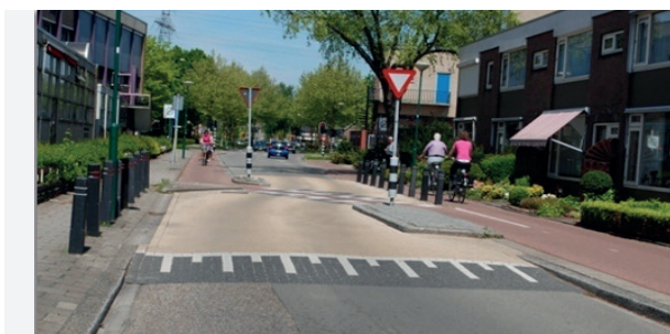
ZDJĘCIE 45. Holandia, Veenendaal. Połączenie dwukierunkowej drogi dla rowerów z pasami ruchu dla rowerów.
