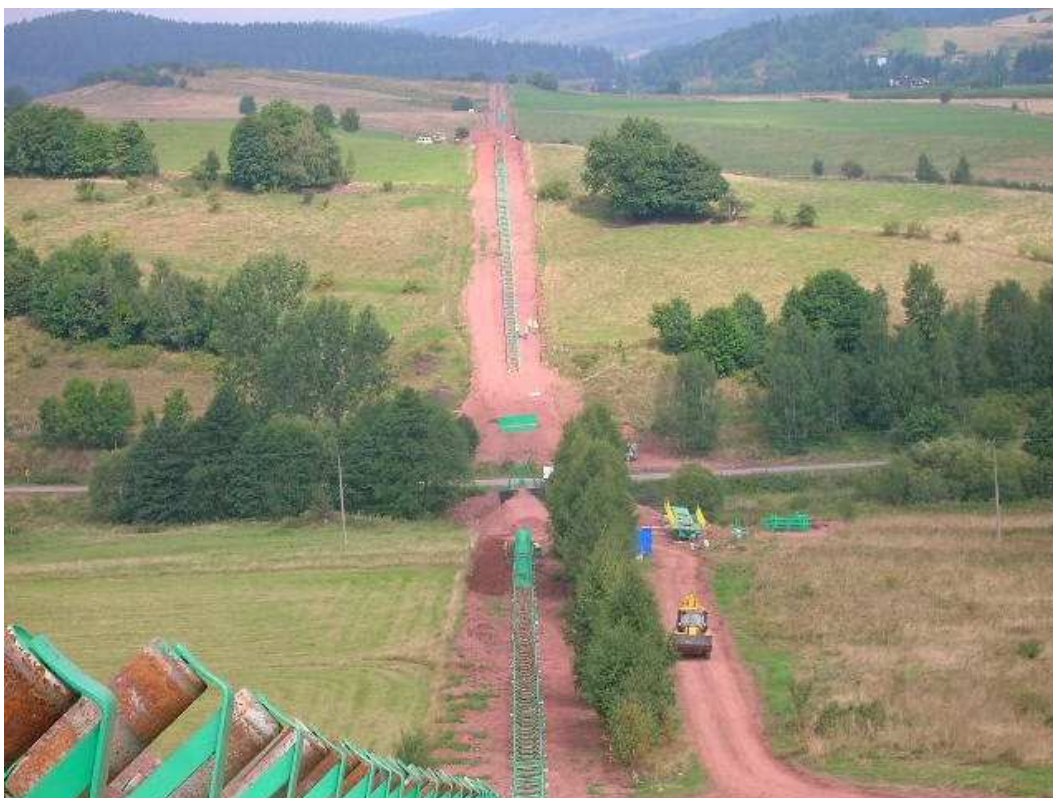
Rys. 2.47. Kopalnia melafiru Świerki - transport przenośnikiem taśmowym o długości 4 km z wyrobisk w Świerkach do stacji kolejowej w Bartnicy (fot. P. Komandowski, 2011)
