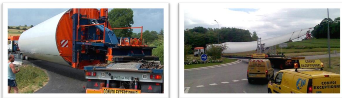
Fotografia 6.5. Przewóz elementów siłowni wiatrowej na drogach obiektach inżynierskich (źródło: http://www.universal-transport.pl/brane/elektrownie-wiatrowe/fahrzeugequipment.html )
